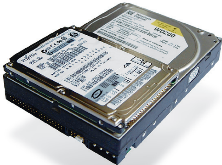
Abb. 3.2 2.5-Zoll HDD auf 3.5-Zoll HDD (aus Wikipedia)
